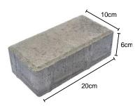
1.4.8.2 As Normas Brasileiras recomendam a utilização de pavimentos com 6cm de altura para as áreas de tráfego de pedestres e veículos leves. Também segundo as Normas Brasileiras a menor resistência à compressão admitida para os pavimentos intertravados é de 35MPa.
